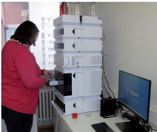
Konfirmácia mykotoxínov v potravinách na novom zariadení vysokoúčinnnej kvapalinovej chromatografie so spektrofotometrickým a fluorometrickým detektorom
