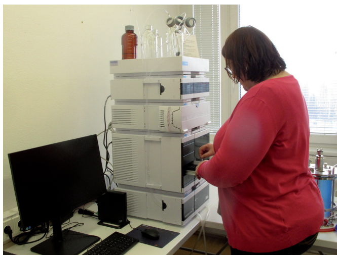
Skríningové analýzy mykotoxínov na novom zariadení vysokoúčinnnej kvapalinovej chromatografie s fluorometrickým detektorom.
